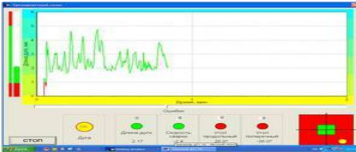
Рисунок 4 – График временной зависимости длины дуги
